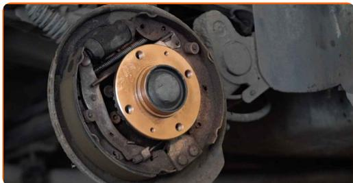
**19** Installieren Sie die Bremstrommel und befestigen Sie diese.
