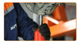
Ziehen Sie das Befestigungselement an, das die Druckstange mit dem Stabilisator verbindet. Verwenden Sie Ring-Gabelschlüssel Nr. 13. Verwenden Sie Stecknuss Nr. 13. Verwenden Sie einen Drehmomentschlüssel. Ziehen Sie ihn mit 18 Nm Drehmoment fest.
