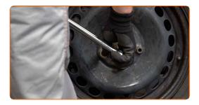
Entfernen Sie den Wagenheber sowie die Unterlegkeile.
