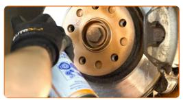
Die Bremsscheibenoberfläche reinigen. Benutzen Sie einen Bremsenreiniger.
