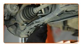
Verwenden Sie Ring-Gabelschlüssel Nr. 13. Verwenden Sie Stecknuss Nr. 13. Verwenden Sie einen Drehmomentschlüssel. Ziehen Sie ihn mit 18 Nm Drehmoment fest.
