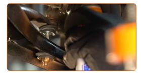
Verbinden Sie das Kugelgelenk mit dem Achsschenkel.
