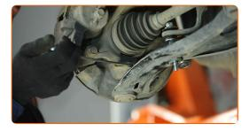
Entfernen Sie den Träger unter dem Arm.
