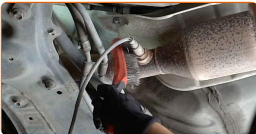
**4** Lösen Sie die Befestigung der Lambdasonde. Verwenden Sie eine 22 mm Lambdasondenstecknuss. Verwenden Sie einen Ratschenschlüssel.
