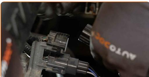
**4** Lösen Sie die Klemme des Kabelbaums des Sauerstoffsensors. Verwenden Sie einen flachen Schraubendreher.
