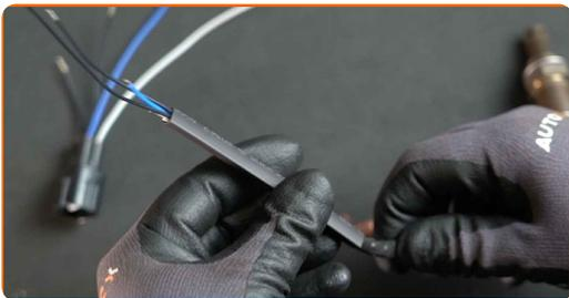
**15** Spleißen Sie die Sauerstoffsensordrähte unter Verwendung von Lötstutzen mit den Steckerdrähten entsprechend der farblichen Markierung zusammen.
