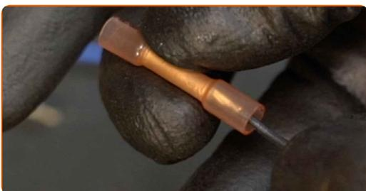
**16** Krimpen Sie die Lötstempel. Verwenden Sie eine Crimpzange.
