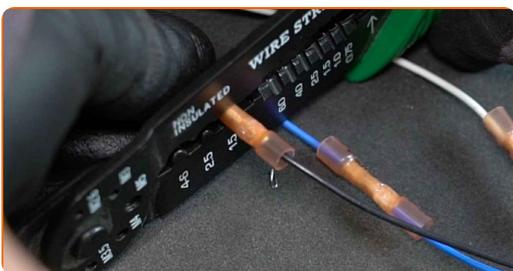
**17** Schrumpfen Sie die Schrumpfschläuche der Lötstempel. Verwenden Sie eine Heißluftpistole.
