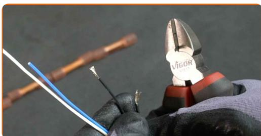
**14** Positionieren Sie den Schrumpfschlauch auf der Verkabelung des Sauerstoffsensors.
