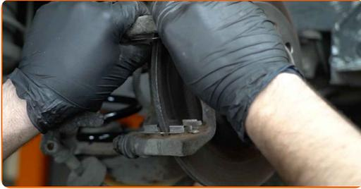
**14** Behandeln Sie den Bremssattel-Kolben. Benutzen Sie eine Drahtbürste. Benutzen Sie einen Bremsenreiniger.
