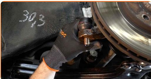
**15** Schrauben Sie die Befestigungsmutter auf, die den Spurstangenkopf mit dem Achsschenkel verbindet. Verwenden Sie Stecknuss Nr. 18. Verwenden Sie einen Ratschenschlüssel.
