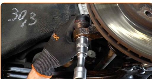
**16** Schrauben Sie die Feststellmutter des Spurstangenkopfes auf. Verwenden Sie Ring-Gabelschlüssel Nr. 22.
