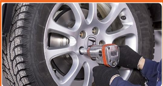
Lösen Sie die Radhalterungsschrauben
