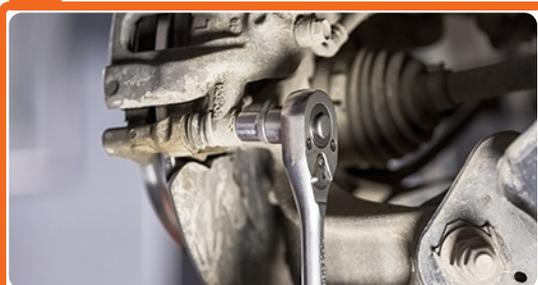
Schrauben Sie die Befestigung des Bremssattels ab
