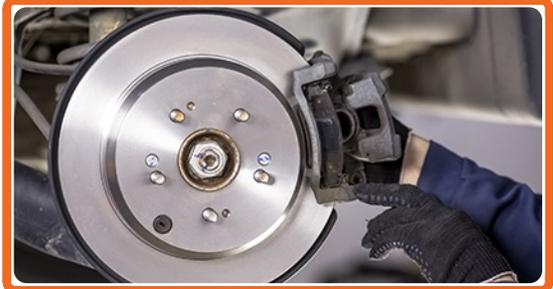
Entfernen Sie den Bremssattel.
