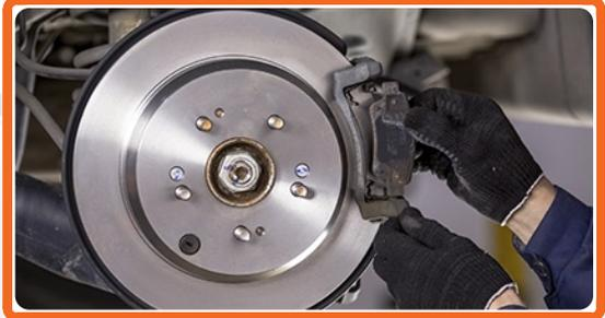
Entfernen Sie die Bremsbeläge
