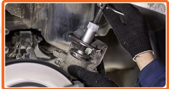
Drücken Sie den Kolben bis zum Anschlag in den Zylinder.
