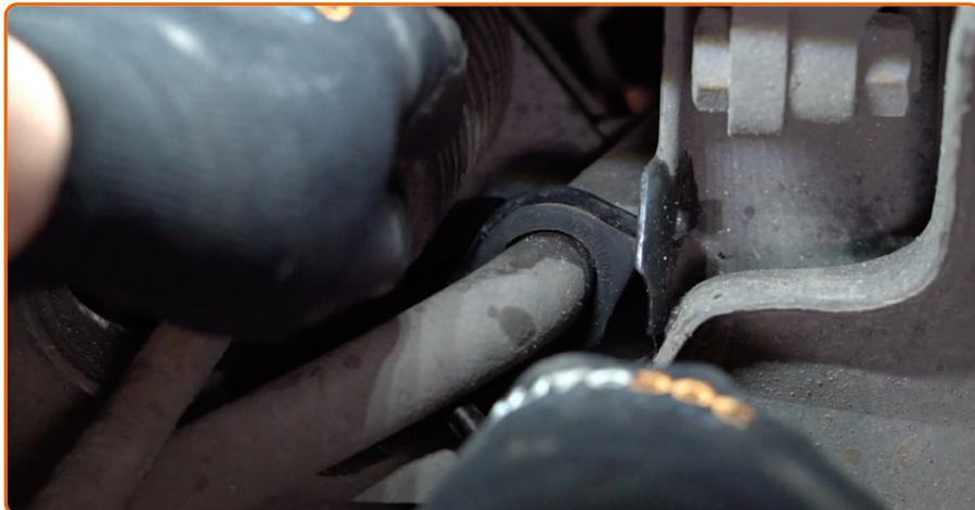
Entfernen Sie die Stabilisatorbuchsen.
