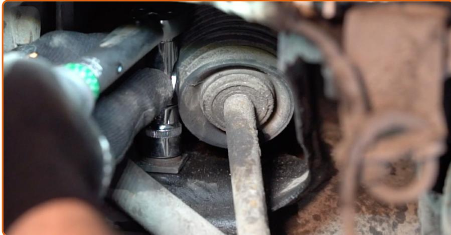
Schrauben Sie die Befestigungen der Stabilisatorbuchsenhalter ein. Verwenden Sie Stecknuss Nr. 16. Verwenden Sie einen Drehmomentschlüssel. Ziehen Sie ihn mit 45 Nm Drehmoment fest.
