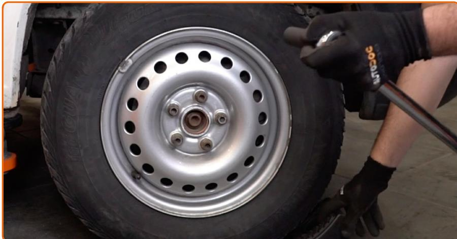
Entfernen Sie den Wagenheber sowie die Unterlegkeile.
