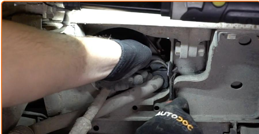
Entfernen Sie die Stabilisatorbuchsenhalter. Benutzen Sie ein Brecheisen.
