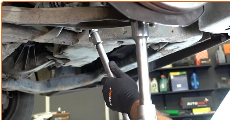
Ziehen Sie das vordere Befestigungselement an, das den Querlenker mit dem Hilfsrahmen verbindet. Verwenden Sie Ring-Gabelschlüssel Nr. 21. Verwenden Sie einen Drehmomentschlüssel. Ziehen Sie ihn mit 80 Nm Drehmoment fest.
