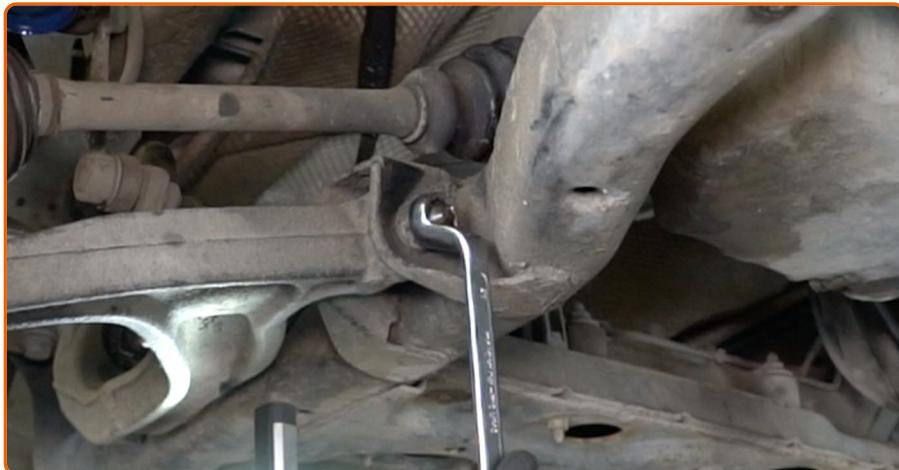
Schrauben Sie das Befestigungselement ein, das den Querlenker mit dem Hilfsrahmen verbindet. Verwenden Sie Ring-Gabelschlüssel Nr. 21.
