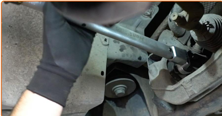
Schrauben Sie die hinteren Befestigungen, welche den Querlenker mit dem Karosseriehilfsrahmen verbinden, fest. Verwenden Sie Ring-Gabelschlüssel Nr. 21. Verwenden Sie einen Drehmomentschlüssel. Ziehen Sie ihn mit 80 Nm Drehmoment fest.
