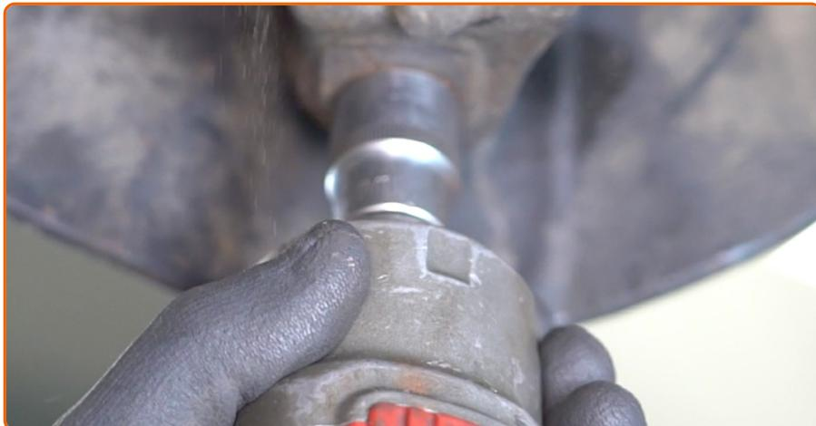
Lösen Sie das Befestigungselement, welches das Kugelgelenk am Federungsquerlenker befestigt. Verwenden Sie Stecknuss Nr. 21. Verwenden Sie einen Ratschenschlüssel.
