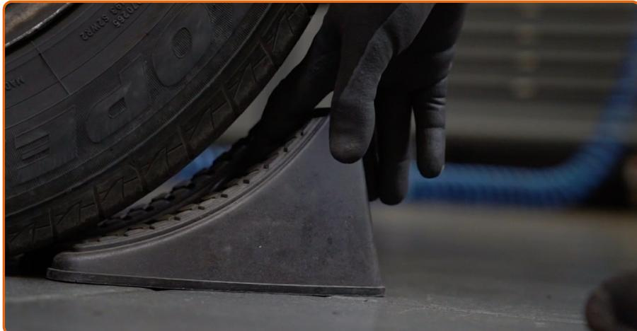
Entfernen Sie den Wagenheber sowie die Unterlegkeile.
