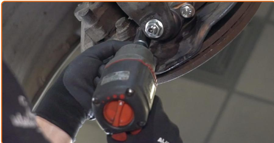
Schrauben Sie das Befestigungselement ein, das das Kugelgelenk mit dem Achsschenkel verbindet. Verwenden Sie Stecknuss Nr. 19. Verwenden Sie einen Ratschenschlüssel.
