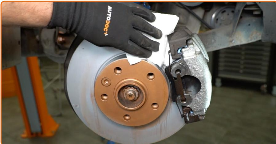
Die Bremsscheibenoberfläche reinigen. Benutzen Sie einen Bremsenreiniger.
