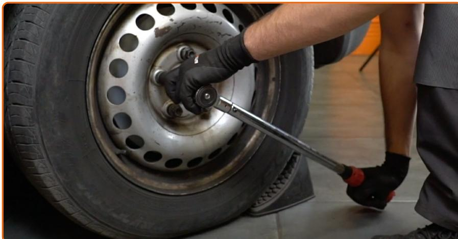
Senken Sie das Auto und ziehen Sie die Radschrauben über Kreuz an. Verwenden Sie eine Schlagnuss für Felgen # 19. Verwenden Sie einen Drehmomentschlüssel. Ziehen Sie ihn mit 120 Nm Drehmoment fest.
