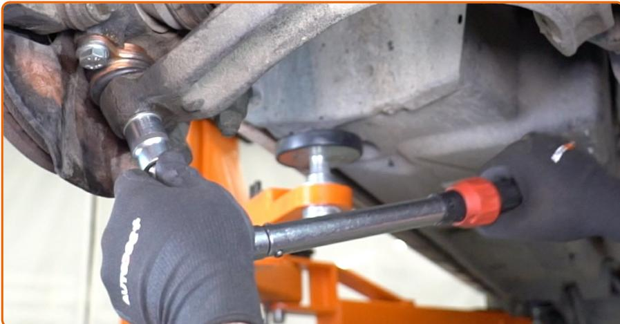
Schrauben Sie die Befestigungen fest, die das Kugelgelenk mit dem Querlenker verbinden.
