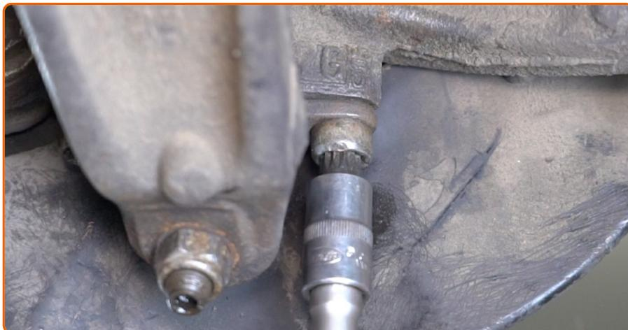
Schrauben Sie die Kugelgelenkbefestigung vom Achsschenkel ab. Benutzen Sie den XZN #14. Verwenden Sie einen Ratschenschlüssel.
