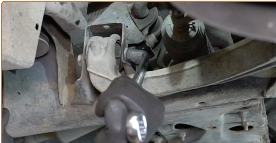
Schrauben Sie das hintere Befestigungselement ein, das den Querlenker mit dem Hilfsrahmen verbindet. Verwenden Sie Ring-Gabelschlüssel Nr. 21.
