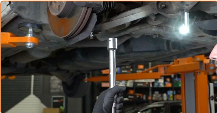
Entfernen Sie den Träger unter dem Arm.
