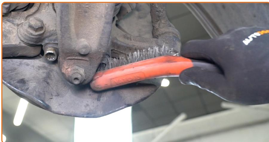
Reinigen Sie alle Verbindungen des Querlenkers. Benutzen Sie eine Drahtbürste. Benutzen Sie WD-40-Spray.
